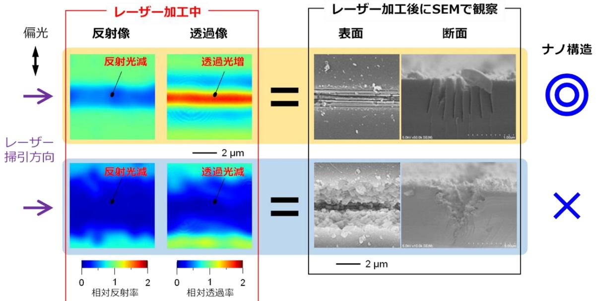
図 1 今回開発した技術による観察結果 (左) と加工後に電子顕微鏡で観察した表面と断面形状 (右)。上段はガラス表面にナノ周期構造が形成された場合、下段は形成されなかった場合の結果。ナノ周期構造が形成されると無反射特性が付与され、反射光は減少する一方で、透過光が増加する (上段) ことがわかる。
