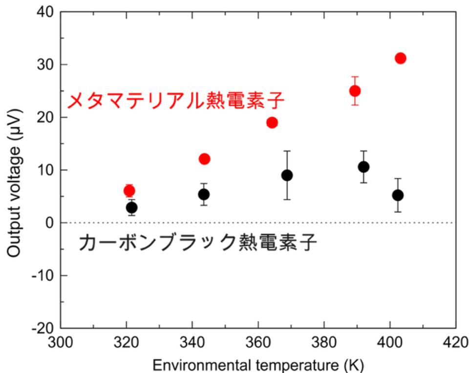
図3 メタマテリアル熱電素子(赤点)とカーボンブラック熱電素子(黒点)の発電特性と環境温度の関係。いずれの環境温度においてもメタマテリアル熱電素子は高い熱電出力を示した。
