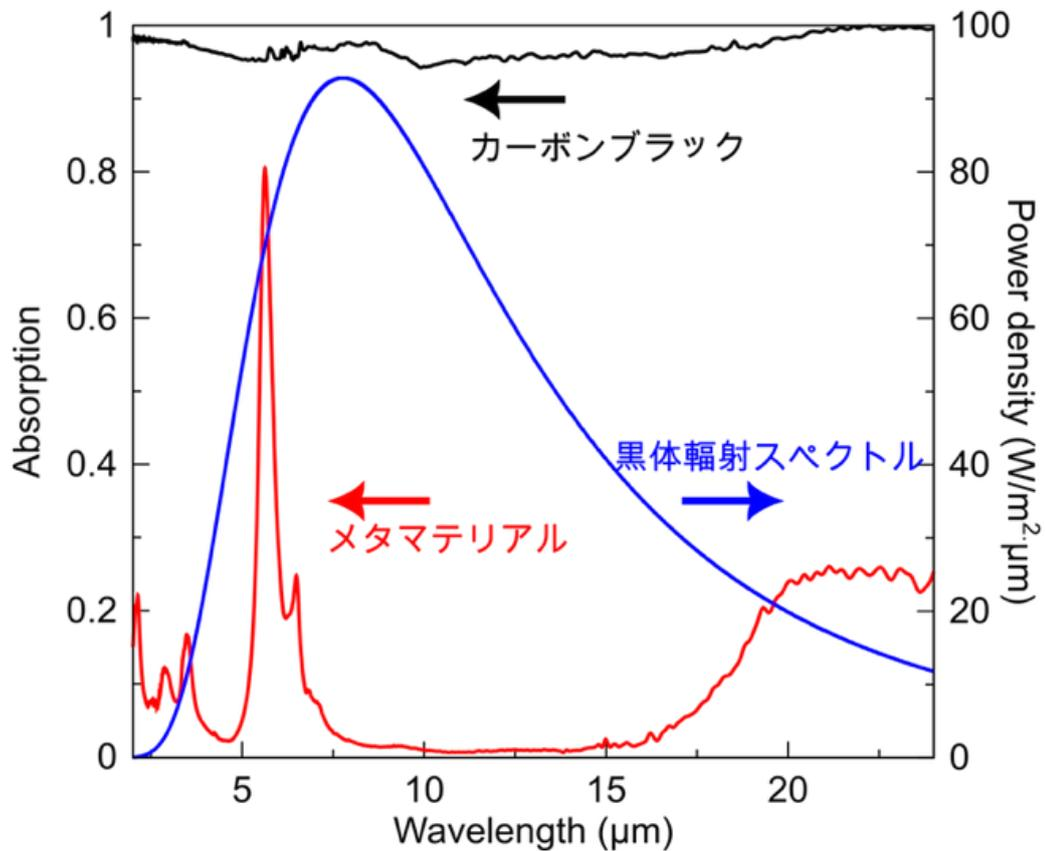
図2 メタマテリアル (構造厚さ:  $0.31 \mu\text{m}$ , 赤線)、カーボンブラック (構造厚さ:  $60 \mu\text{m}$ , 黒線)の吸収スペクトルと、熱エネルギーのスペクトルを示す黒体放射スペクトル (100度) (青線)の比較。メタマテリアルはカーボンブラックよりも帯域・強度の点において低い熱放射吸収特性を示すことから、メタマテリアルの熱エネルギー吸収はカーボンブラックのそれよりも低いことがわかる。
